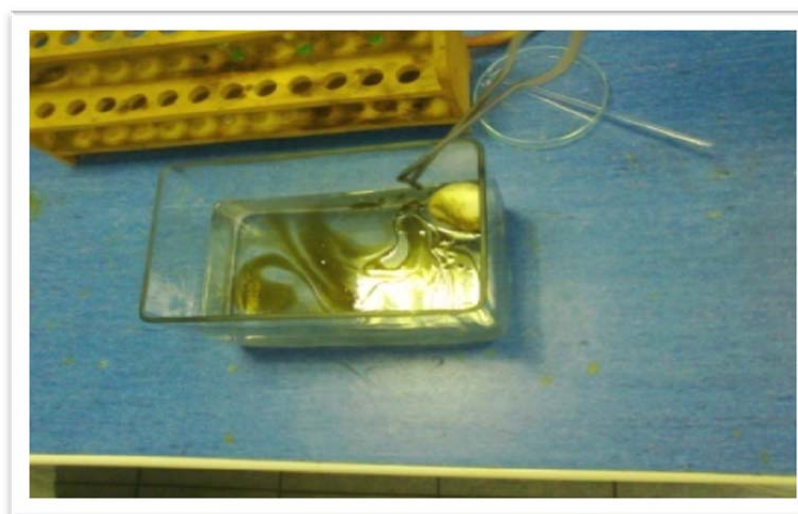
Obrázok 3 Účinok Vapexu na ropnej škvrne
