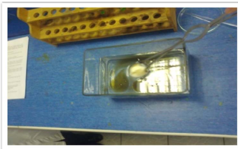
Obrázok 2 Pridanie Vapexu na ropnú škvrnu
