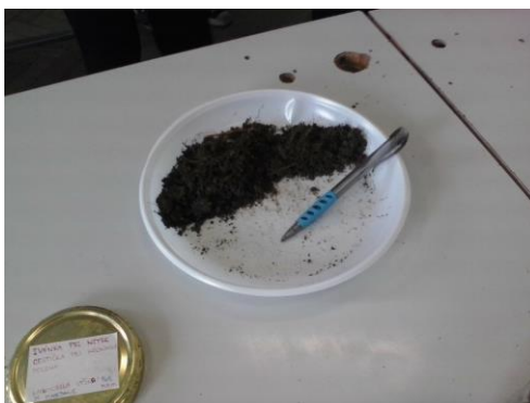
Obrázok 4 Rozbor zrnitosti pôdnej vzorky
